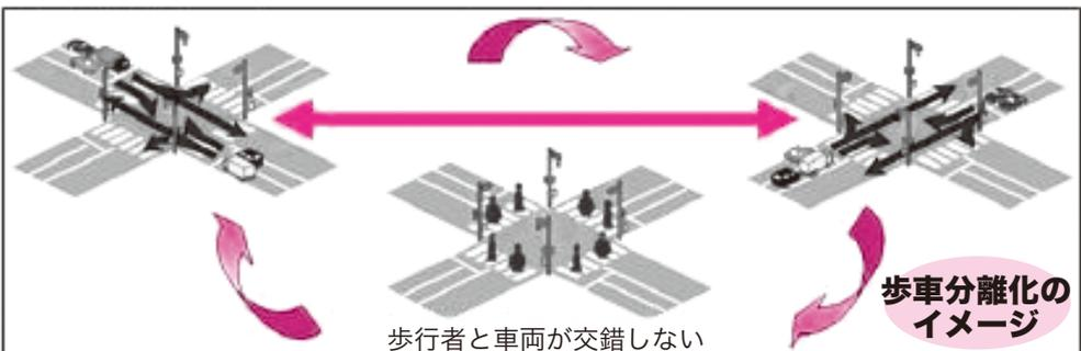
押しボタン式の場合、押しボタンが押されるまでは ← → が繰り返されます。押しボタンが押されると、全方向の車用の信号機が赤色になり歩行者用の信号機だけが全て青色になります。
