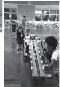
この装置は、発射台のレール上の定位置に紙飛行機を置き、「発射ボタン」を押すと、自動的に紙飛行機が装置の先端まで運ばれ、カウントダウンの音声が流れた後、紙飛行機を発射させるもので、10m以上も飛んだ紙飛行機もありました。園児の皆さんは、「すごく遠くまで飛んだ!」「列車のように勝手に動くのが不思議」と大喜びしながら、『とびお君』と仲良く遊びました。
